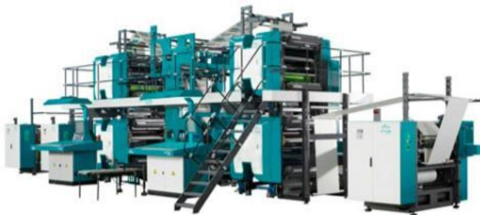
Производительность 35 000 отт/час. CityLine Express является машиной классической компоновки - одинарный диаметр цилиндра и одинарная ширина полотна, предназначена для изготовления преимущественно однокрасочной газетной продукции на предприятиях с небольшим и средним объемом производства. В стандартной комплектации газетные комплексы CityLine Express имеют все оснащение, необходимое для производства высококачественной газетной продукции.
