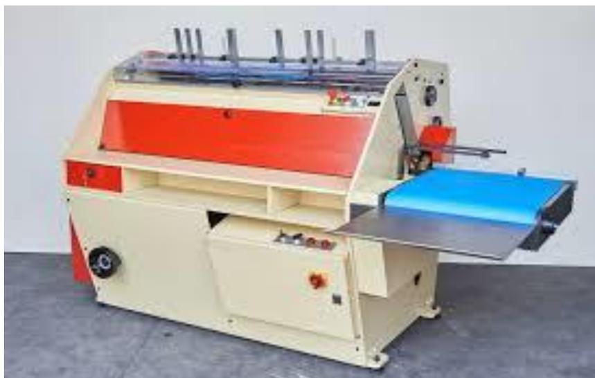
Gluematic предназначен для приклейки форзацев, листов и тетрадей. Он отличается компактной конструкцией, простотой в управлении, быстрой подготовкой к работе и точной приводкой.
