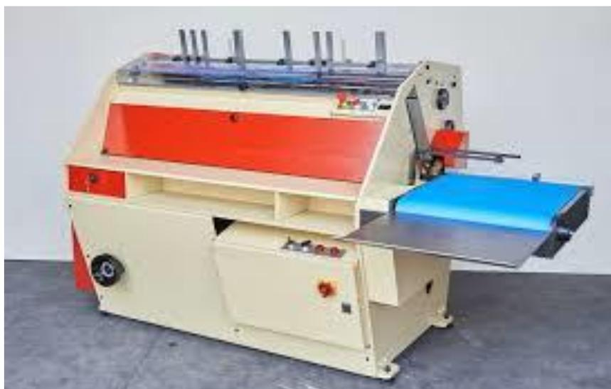
Glumatic предназначен для приклейки форзацев, листов и тетрадей. Он отличается компактной конструкцией, простотой в управлении, быстрой подготовкой к работе и точной приводкой.
