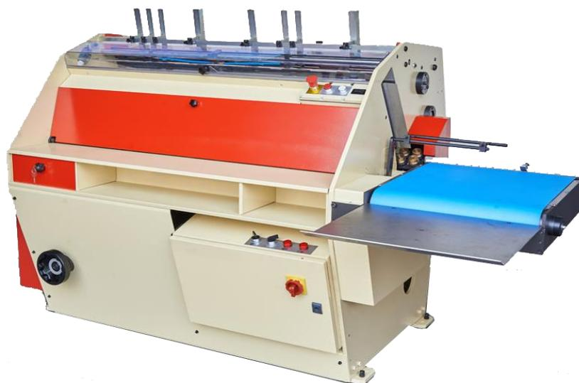
Glumatic предназначен для приклейки форзацев, листов и тетрадей. Он отличается компактной конструкцией, простотой в управлении, быстрой подготовкой к работе и точной приводкой.
